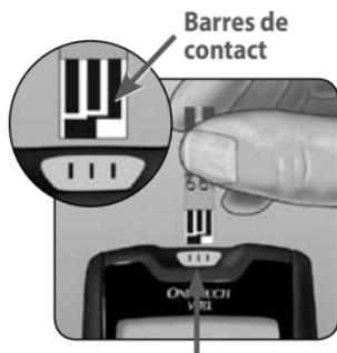
Fente d'insertion des bandelettes réactives
